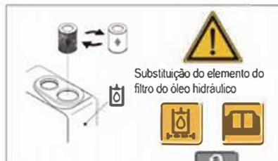
Mensagem de advertência sobre a necessidade de substituição do filtro do óleo hidráulico.
