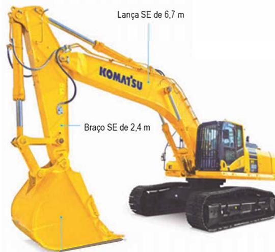
Carga máxima total permitida (peso do material + peso da caçamba): 8180 kg
