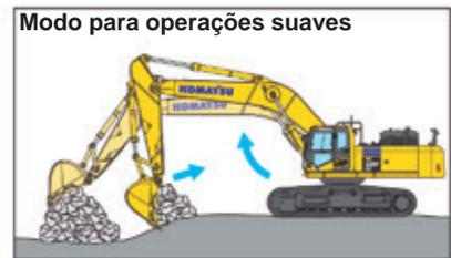
A lança flutua na ascendente, reduzindo a elevação da dianteira da máquina em relação ao solo, o que torna a caçamba apta a carregar com mais facilidade rochas dinamitadas e executar a raspagem do solo.
