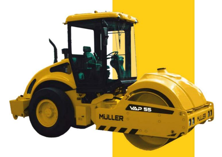
COMPACTADOR VIBRATÓRIO ASFALTO
